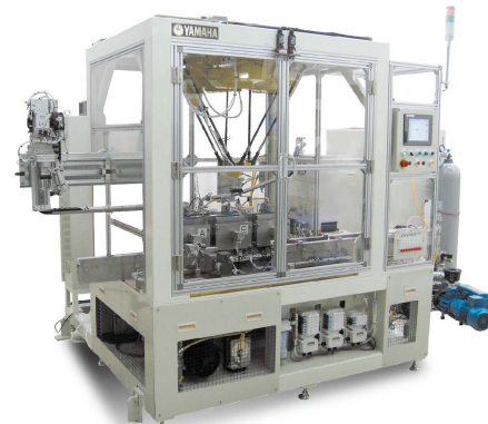
電池漏れ検査装置
