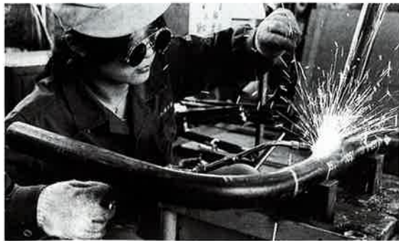
鉄管を熱して曲げ、接続します。「鉄管曲げは好きだった」と語る。(昭和54年技能五輪配管部門国内大会優勝当時)
